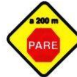
PROXIMIDAD DE SEÑAL RESTRICTIVA (PARE)
